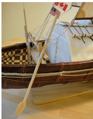
Fig. 31 - Il governale, posto a tribordo, affrancato con legature al telaio ad H.
