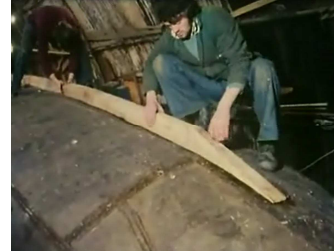
Fig. 26 - Irrobustimento esterno della chiglia.
