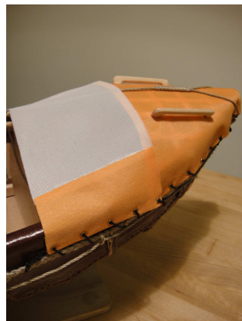
Fig. 43 a,b – Coperture dei ripostigli. A prua (a) è visibile anche una copertura mobile, bianca nella parte centrale. A poppa (b) è presente solo la copertura fissa.
