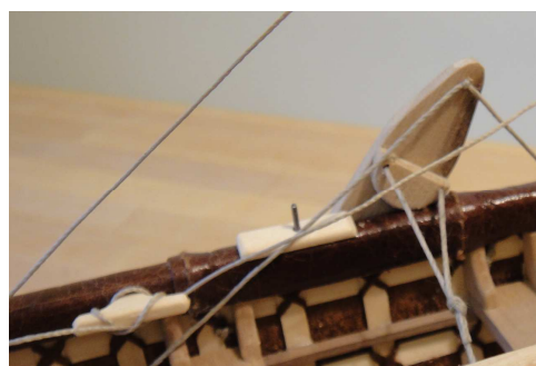
Fig. 32 - Particolare della deriva mobile di babordo vista dall'interno.
